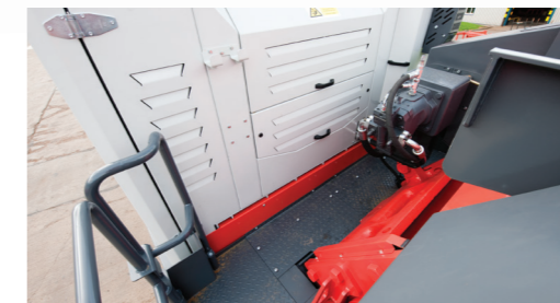
Einfacher Zugang zum Motorbereich
