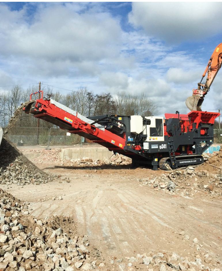
Optionaler Hydraulikbrecherarm mit Hammer- und Aufgabetrichterverlängerungen
