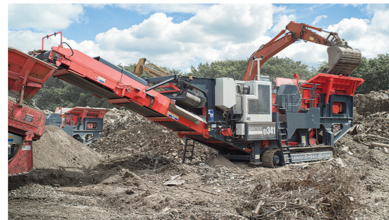
Optionaler Hydraulikbrecherarm mit Hammer- und Aufgabetrichterverlängerungen
