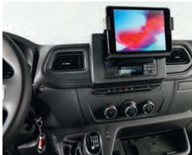
AUSZIEHBARE TABLET-HALTERUNG in das Armaturenbrett integriert, auch für A4-Dokumente nutzbar.
