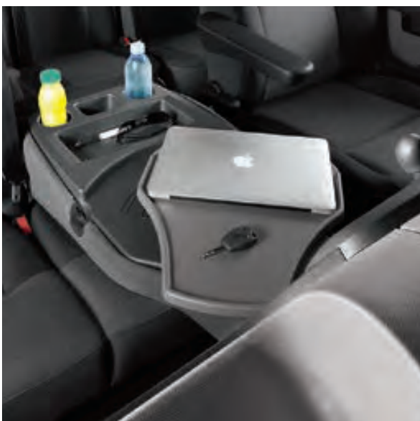
NOTEBOOK-HALTERUNG mit Ablagefach, zwei Flaschenhaltern und Drehtisch auf der Rückseite des Klappsitzes.
