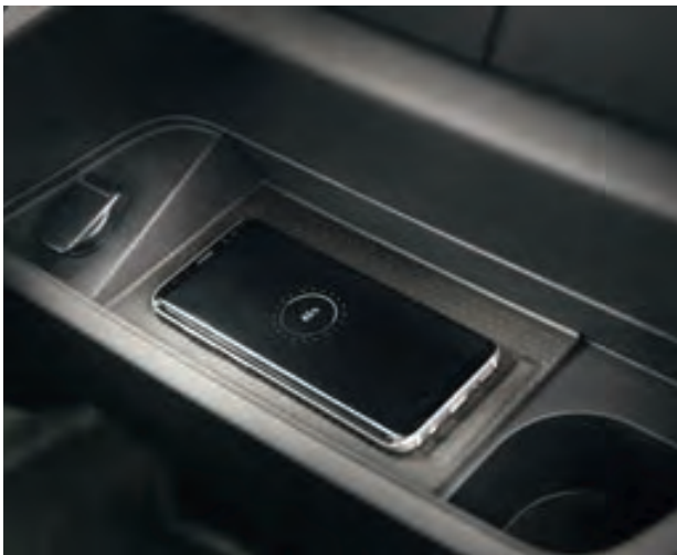
DRAHTLOSE SMARTPHONE-LADESTATION mit dem Qi-Standard konform.
