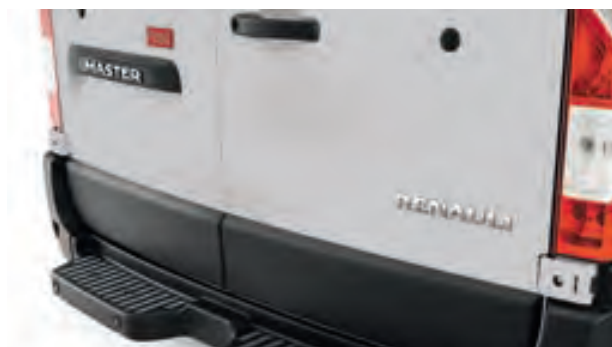
HINTERE TRITTSTUFE ab 436 mm.
