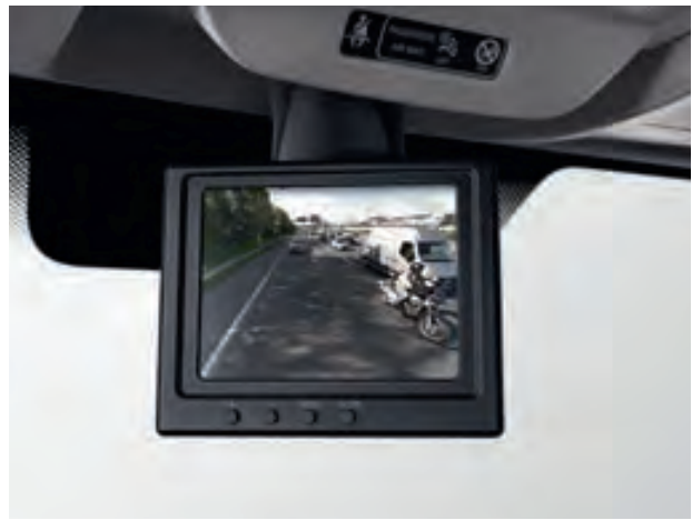
3 PERMANENTE SICHT NACH HINTEN durch die Kamera hinten am Dach, die beim Fahren den Blick in den Innenspiegel ersetzt.
