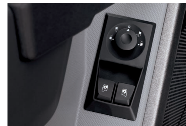
SEITENSCHIEBEN UND AUSSENSPIEGEL Impulsfensterheber und elektrische Einstellung der Rückspiegel.
