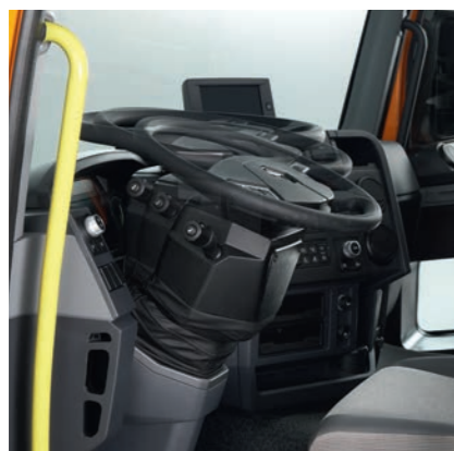
3-FACH VERSTELLBARES LENKRAD vom Fahrer individuell in Höhe und Neigung einstellbar.
