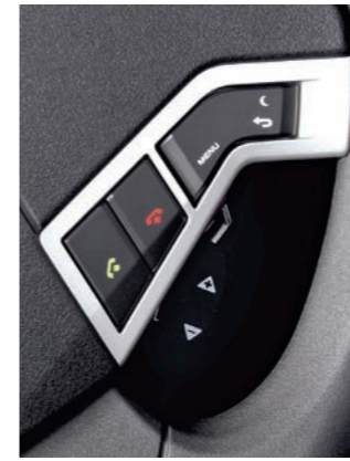
BEDIENUNG AM LENKRAD für Telefon und Menüsteuerung.
