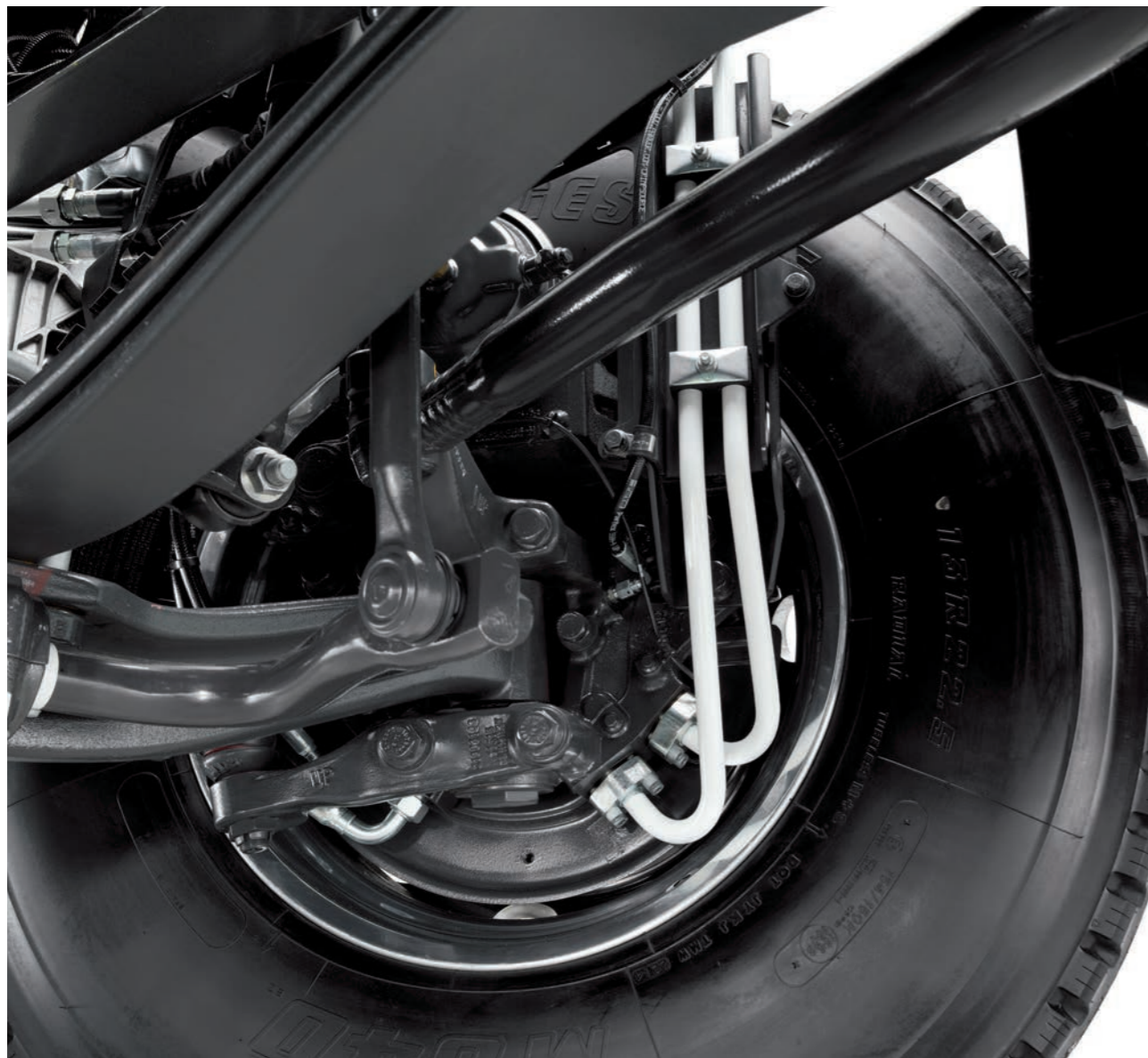
VORDERACHSE AUSGESTATTET MIT 2 HYDRAULIKMOTOREN mit einer Leistung von je 41 kW.
