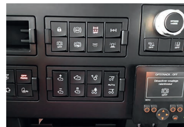
EIN- UND AUSSCHALTEN DES SYSTEMS mithilfe eines einfachen Schalters auf dem Armaturenbrett bei einer Geschwindigkeit von 0 bis 25 km/h.
